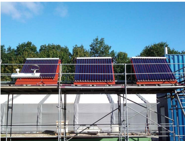
Figur 1. Foto af solfangerne SEIDO1-16, SEIDO5-16 og SEIDO10-20 under afprøvning i DTU's prøvestand for solfangere.
